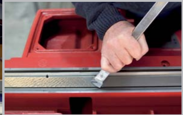
Handgeschabter, gealterter Guss, in einer Präzision +/-1 \mu
